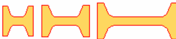
Figura A.2-12: Ejemplos de perfiles en bruto para laminación de perfiles [EUROFER HR].
