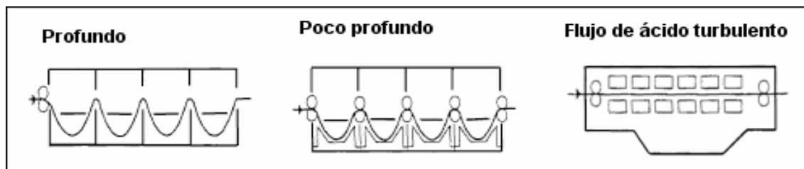
Figura A.4-15: Distintos tipos de tanques de decapado
